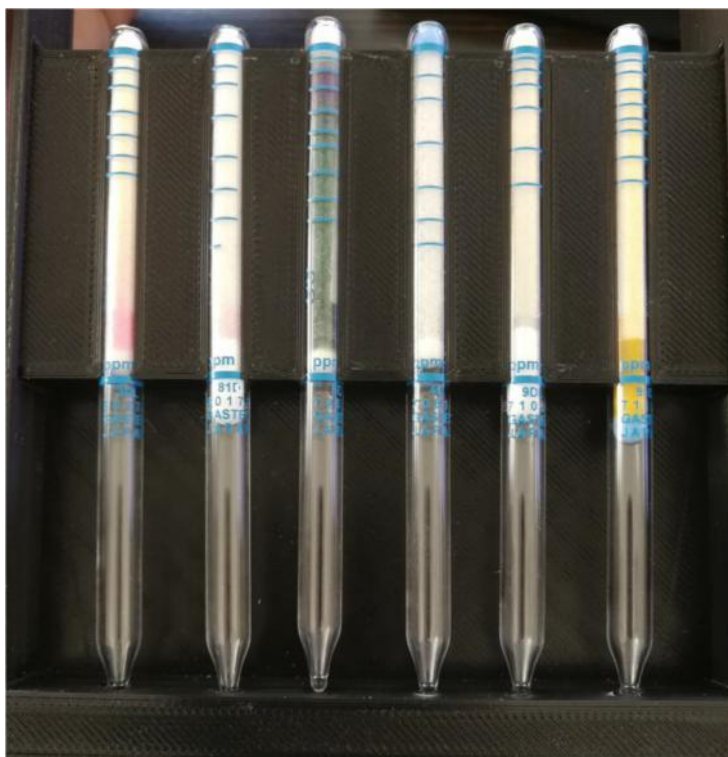
Εικόνα 5: Η ορθή τοποθέτηση των αισθητήρων εντός του αποσπώμενου συστήματος.
