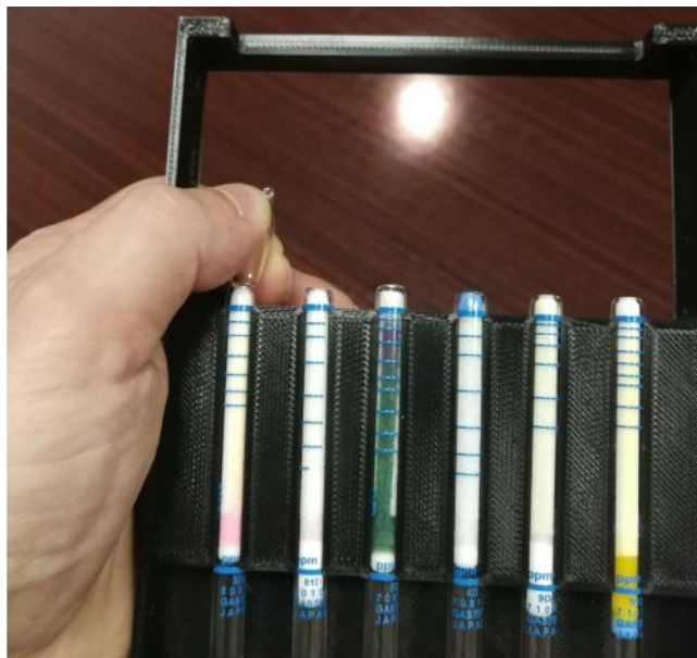
Εικόνα 6: Η ορθή διαδικασία ανοίγματος των αισθητήρων στο αποσπώμενο σύστημα.
