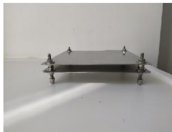
Εικόνα 3.7: Μεταλλικές πλάκες από ανοξείδωτο ατσάλι, ανάμεσα στις οποίες τοποθετήθηκαν φίλτρα από ίνες χαλαζία.
