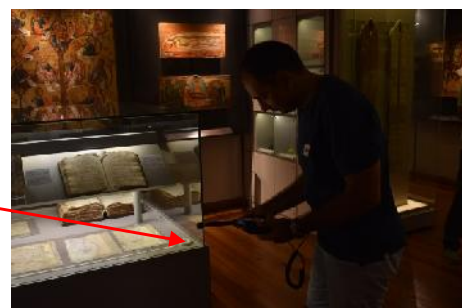
Εικόνα 3.8: Θέσεις τοποθέτησης φίλτρων από χαλαζία εντός προθηκών στην αίθουσα El Greco
